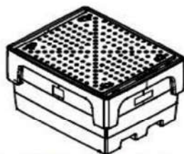
Typ 7 (Einfachstation mit Stütz Kreuz und PE-Lochplatte, 1000 l)
