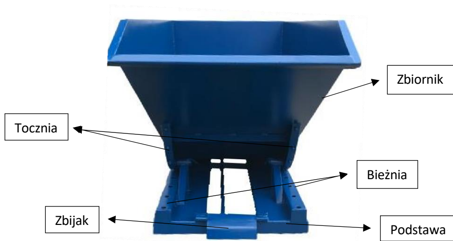
Rys. 2. Konstrukcja kontenera samowyładowczego - przód
